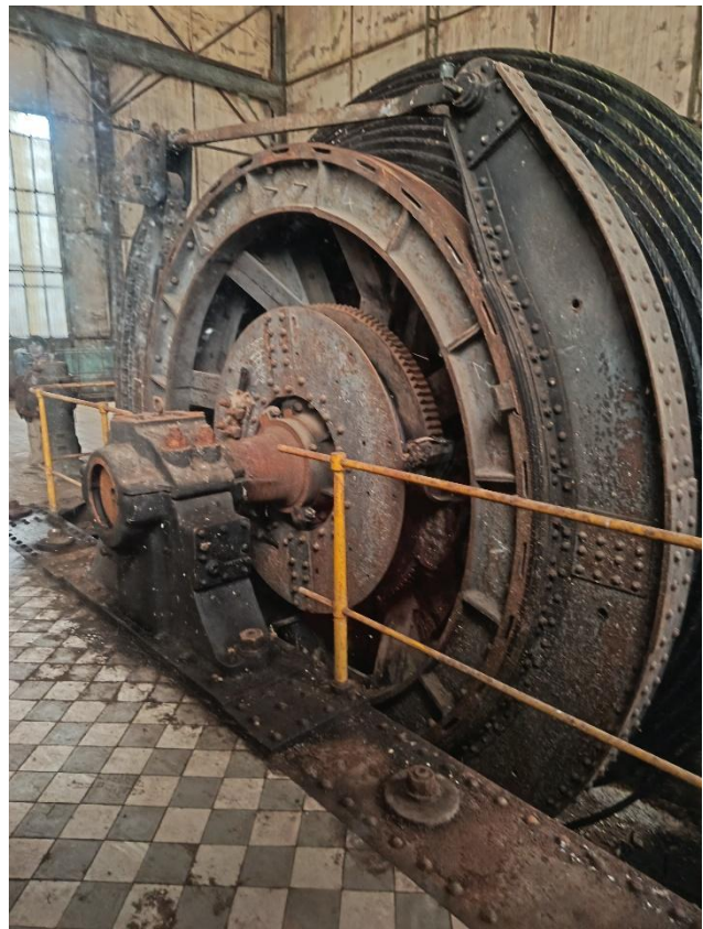
Le treuil permettant la descente des mineurs à 800 m dans une cage spécifique ou la remontée du minerai de fer.
